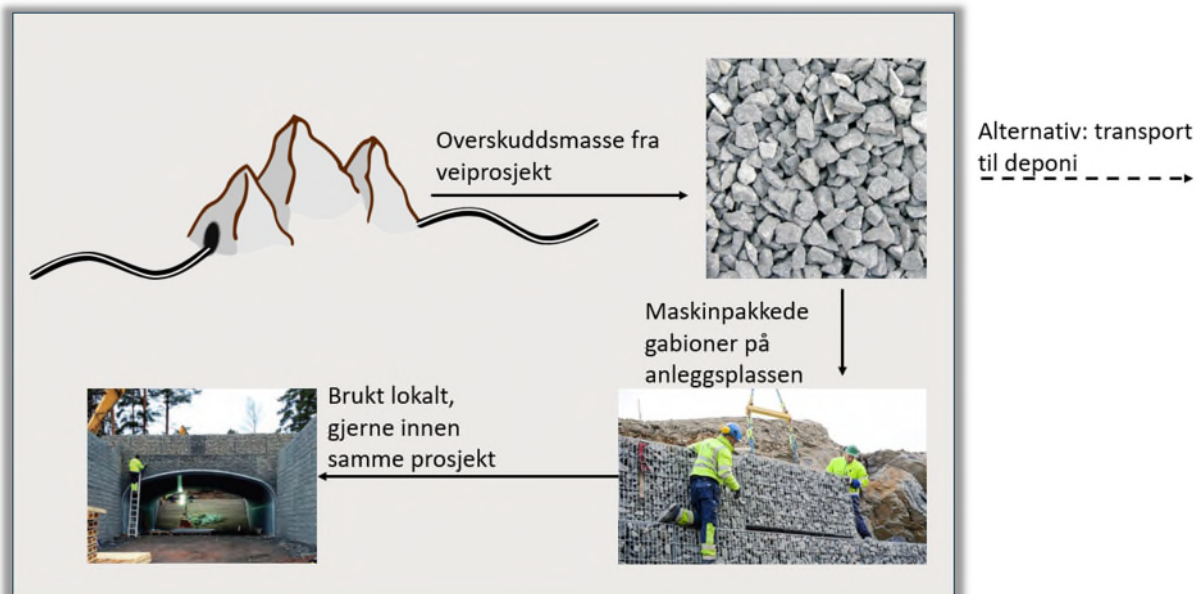
Figur 1 Systemgrenser for livsløpsvurdering av gabioner
